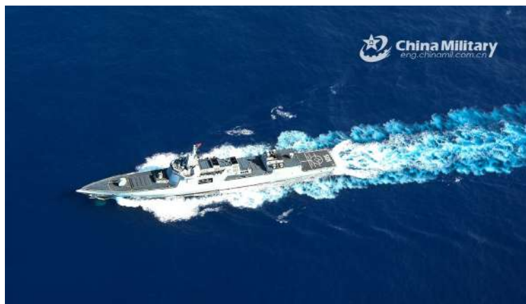
Vue aérienne d'un croiseur Type 055 Renhai de la PLAN. Conçu pour le combat en haute mer et la défense antiaérienne. Noter les nombreux containers VLS derrière le canon de poupe et le bloc-passerelle 12 .
