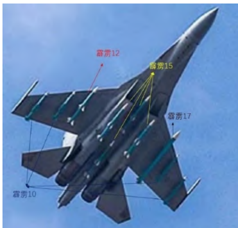
Un J-16 en démonstration armé de toute la gamme PL (霹雳 10/12/15/17) - PL-10 : combat rapproché (IR) ; PL-12 : moyenne portée ; PL-15 : longue portée BVR ; PL-17 : très longue portée 31 .
